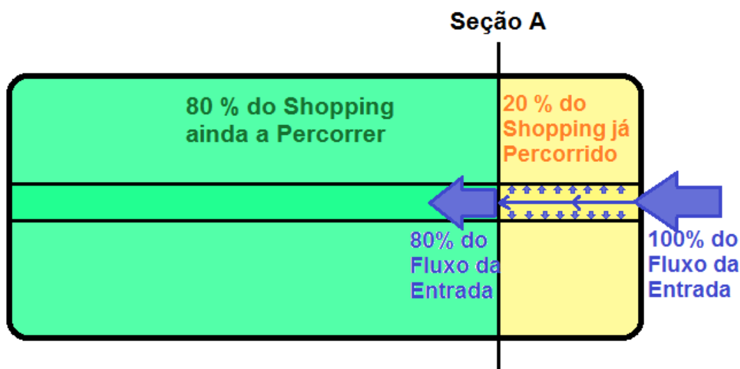
Figura 4.5 – Esquema de Distribuição do Fluxo de uma Entrada pelos Corredores do Shopping
