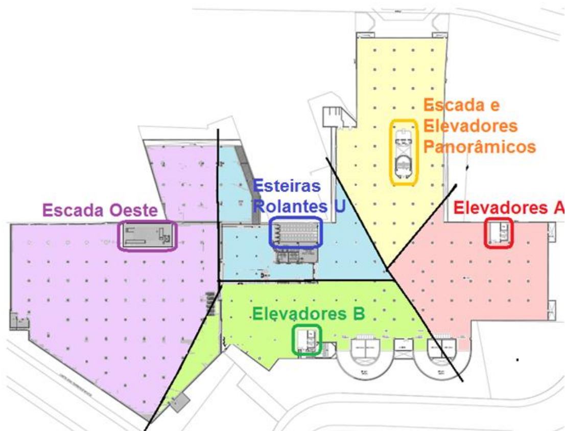
Figura 4.4 – Esquema das Áreas de Influência dos Elementos Verticais nas Garagens
